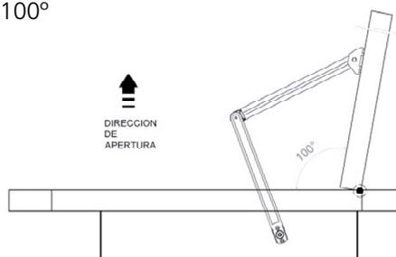
**Brazo de empujar (APR02) - operador en la puerta - en el lado de las bisagras**
