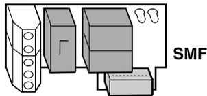
**Sentido de giro:** compruebe el funcionamiento mediante los minipulsadores PUL1 (cerrar) y PUL2 (abrir). Si el sentido de giro de algún accionador no es correcto, intercambie los cables conectados en las bornas G1 y G2 ó G4 y G5.
