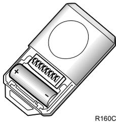
**3** Coloque los DIPs como muestra la figura (DIP1=ON, DIP4=ON). DL3 se ilumina indicando modo de grabación activado.
