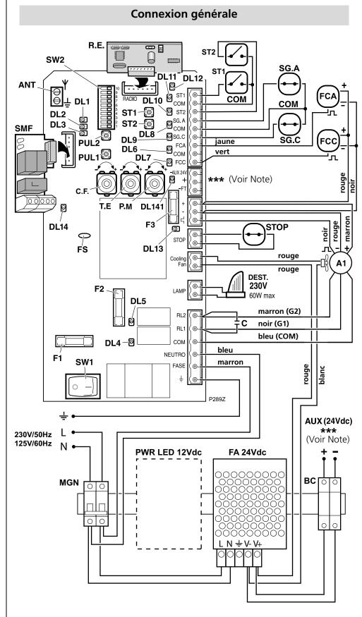
\*\*\*NOTE: si vous installez des accessoires alimentés en 24Vdc (photocellules, etc.), ne les connectez pas aux bornes du panneau de commande, mais aux bornes externes BC-AUX (24Vdc), situées sur le rail DIN, qui sont alimentées par l'alimentation auxiliaire de 24Vdc (FA 24Vdc).
