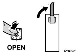
**3** Pulse SET para grabar la posición de apertura. El display muestra P2.
