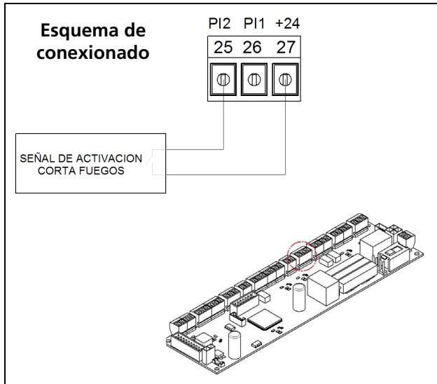
En las puertas configuradas como Corta fuegos, se debe instalar el dispositivo de detección de humos (o la señal de activación) para la función de corta fuegos. Para reanudar la puerta se debe realizar un reset.
