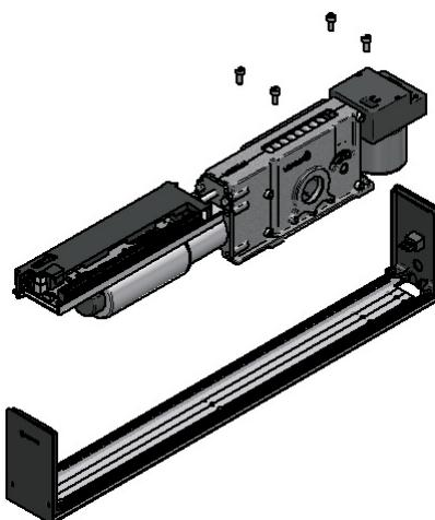
⚠ Fijar el soporte a la pared con las tapas laterales ya que la cota X está referenciada sobre la cara exterior de la tapa (ver planos de instalación).
