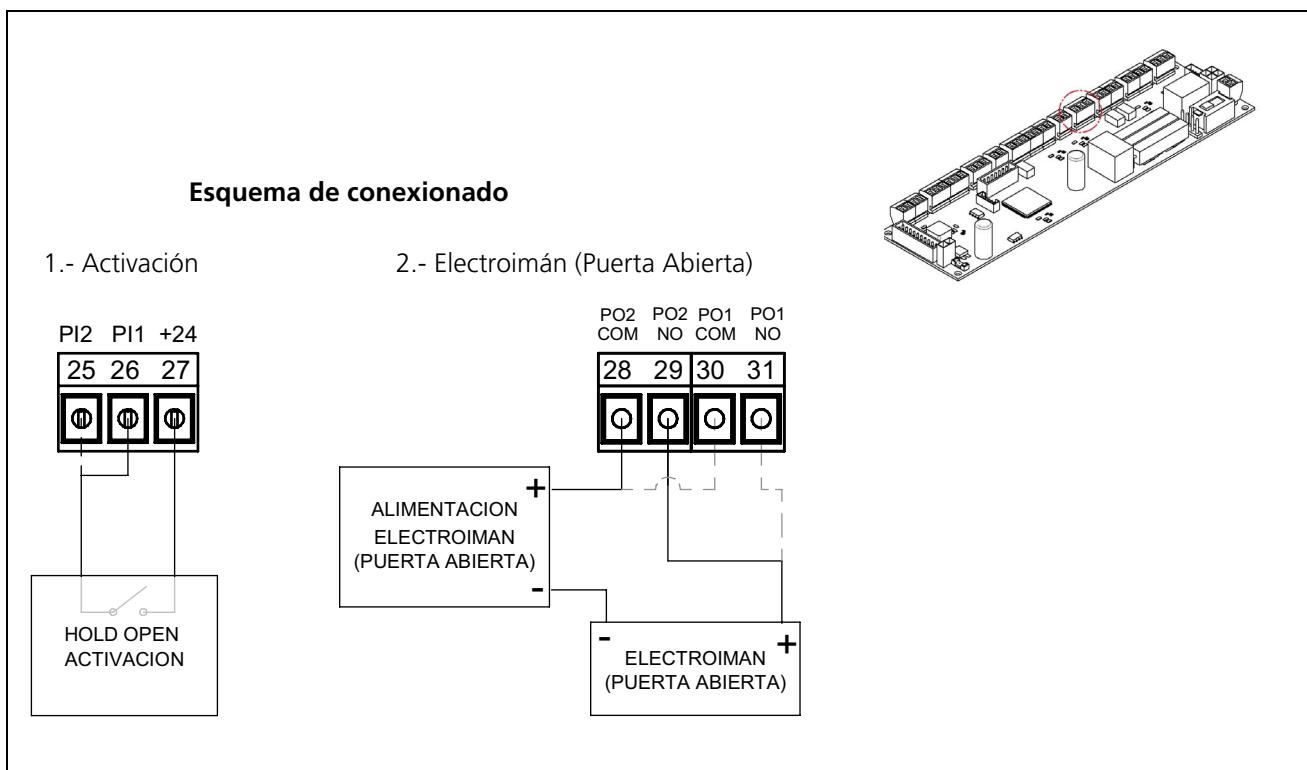
Se puede configurar una entrada programable (PI1 o PI2) para que su pueda mantener la puerta abierta mediante dispositivos de Hold open (p.ej. electroimanes).
