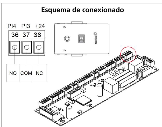
Conectar los cables del interruptor lateral según el siguiente esquema de conexiónado.
