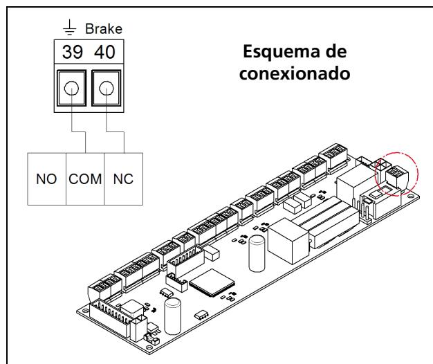
Para que el freno pasivo actúe, el contacto tiene que estar cerrado. En el caso de instalar el microswitch para desactivar al final del cierre el freno pasivo se debe conectar de la siguiente forma (esquema de conexiónado).
