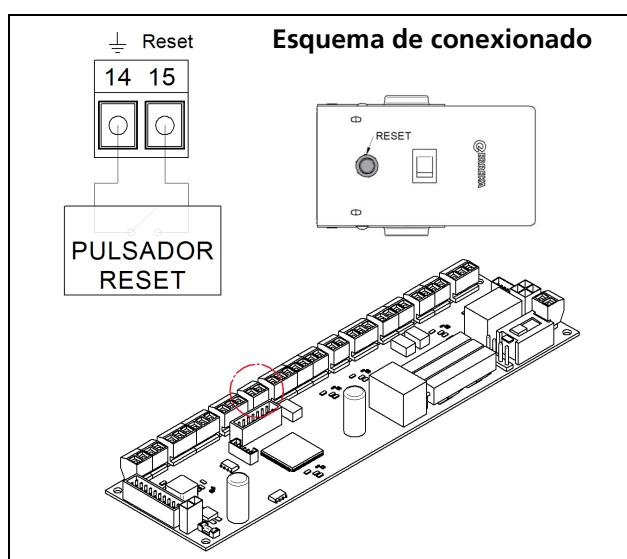
Al activar la señal se hace un reset directo al microprocesador de la placa electrónica. El operador realizará el proceso de reinicialización, pero sin realizar la secuencia de apertura y cierre de la(s) hoja(s).
