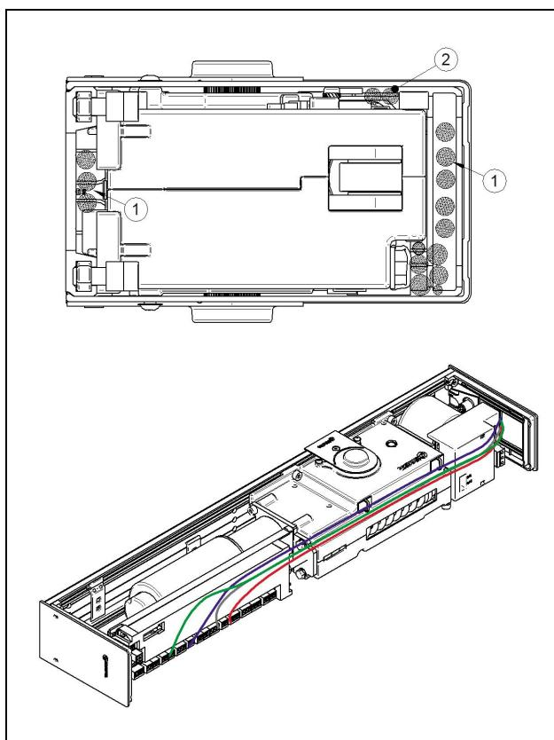
Debido al diseño compacto del operador, el cableado interno del operador se debe hacer de una forma ordenada para no tener problemas a la hora de poner la tapa.
