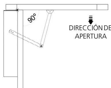
**Brazo rígido especial de tirar (APR09) - operador en el dintel - en el lado de las bisagras**
