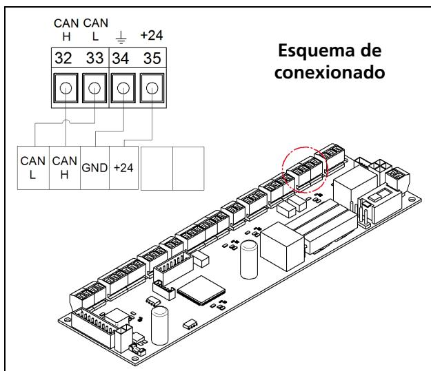
Instalar el selector Digital o selector Rotativo según el siguiente esquema de conexiónado.
