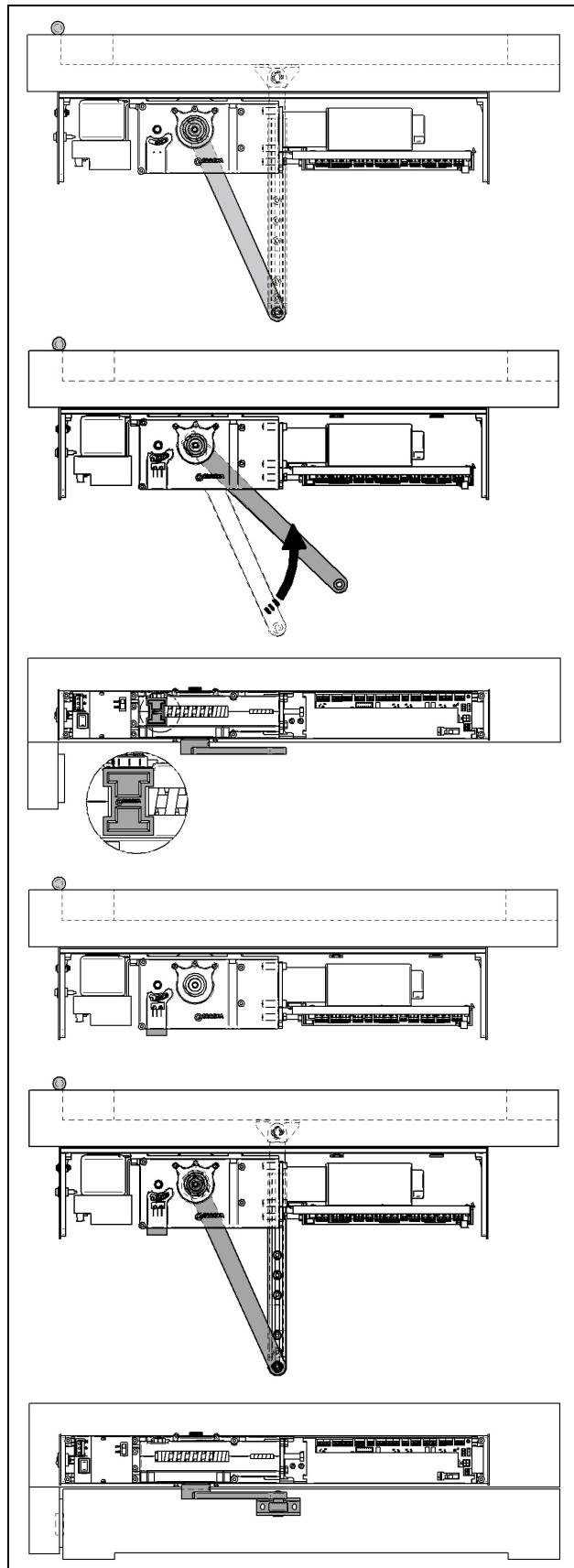
1 Fijar el brazo en la posición en la que el brazo va a estar con la puerta cerrada.
