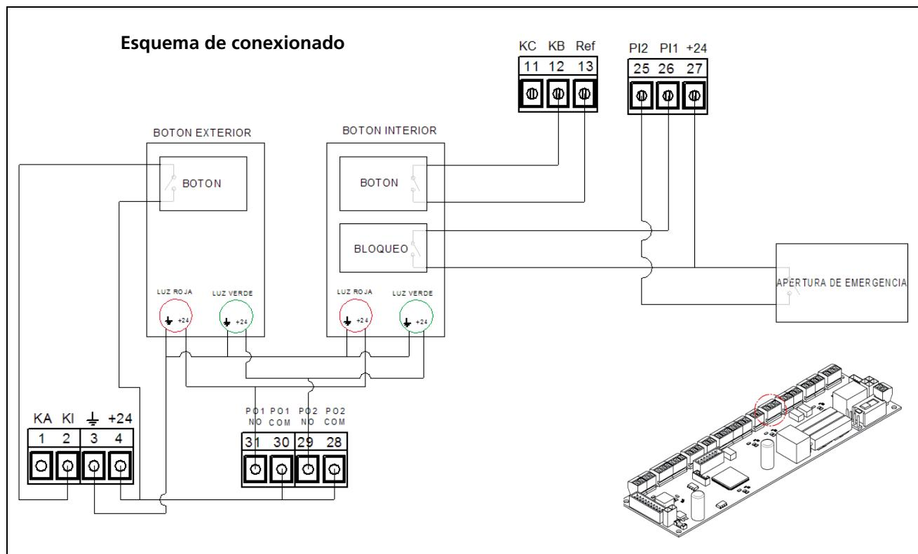
⚠ Al seleccionar en el selector la opción de baños accesibles, todas entradas y salidas programables (PI1, PI2, PO1 y PO2) necesarias se configurarán automáticamente.
