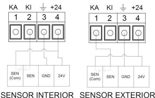
Se pueden instalar los siguientes tipos de dispositivos: sensores de movimiento de radar, sensores de movimiento de infrarrojos pasivos, pulsadores, interruptores, radio, receptores IR, sistemas de control de acceso, sistemas telefónicos y de intercomunicación, etc.
