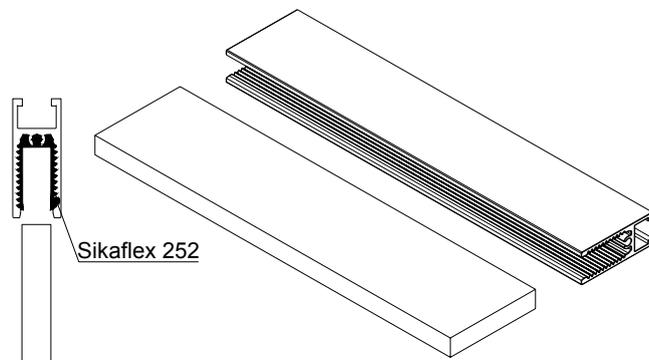
1.2- Fijar la pinza inferior aplicando silicona a la pinza. Se debe ir metiendo la pinza poco a poco con un martillo de plástico e ir midiendo la longitud de hoja hasta conseguir la medida que se necesita para la instalación.
