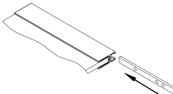
1.4- Fijar las tapas laterales de la pinza superior con 2 tornillos avellanados por cada tapa.
