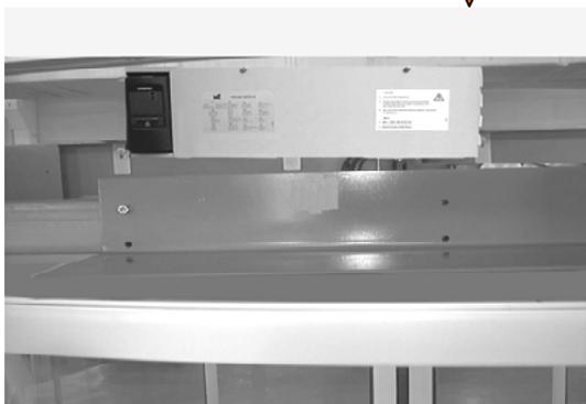
Alinee los cuatro orificios en la parte inferior de la unidad de control con los orificios situados en la parte superior del bastidor. Sujete la unidad de control al bastidor con cuatro tornillos hexagonales y cuatro separadores  $\Phi 8$  con un espesor de 5 mm (los separadores se colocan entre la unidad de control y el bastidor).
