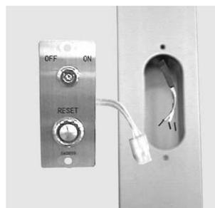
Alinee los orificios, sujete el botón con los dos tornillos hexagonales de cabeza plana M4X30 según se indica, y, a continuación, enchufe el adaptador C05 en el adaptador de la unidad de control C05.
