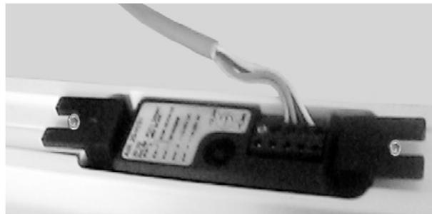
Sujete el AIR20 con la llave hexagonal y 2 tornillos hexagonales de cabeza redonda M4 X 16. Conecte blanco, marrón, verde y amarillo con 1, 2, 3 y 4 por separado, tal como se muestra en la figura. Instale el otro AIR20 siguiendo el mismo procedimiento.
