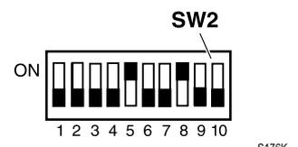
\*: Si emplea accionadores hidráulicos con amortiguación, el paro suave lo realiza el accionador de forma mecánica (DIP8 = OFF)
