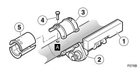
4 Ajuste el accionador al eje, bloqueándolo mediante el tornillo con tuerca (6).
